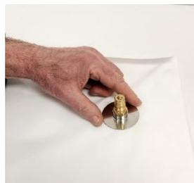
k) Serrer au couple avec le tournevis dynamométrique fourni dans le kit de changement de poche jusqu' à entendre 2 « clics ».
