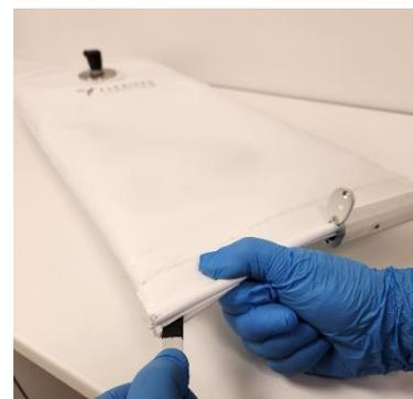
d) Positionner les plis en Z côté opposé à ce premier coin à l'aide de la spatule en veillant à ne pas abîmer les poches ou créer des faux plis.
